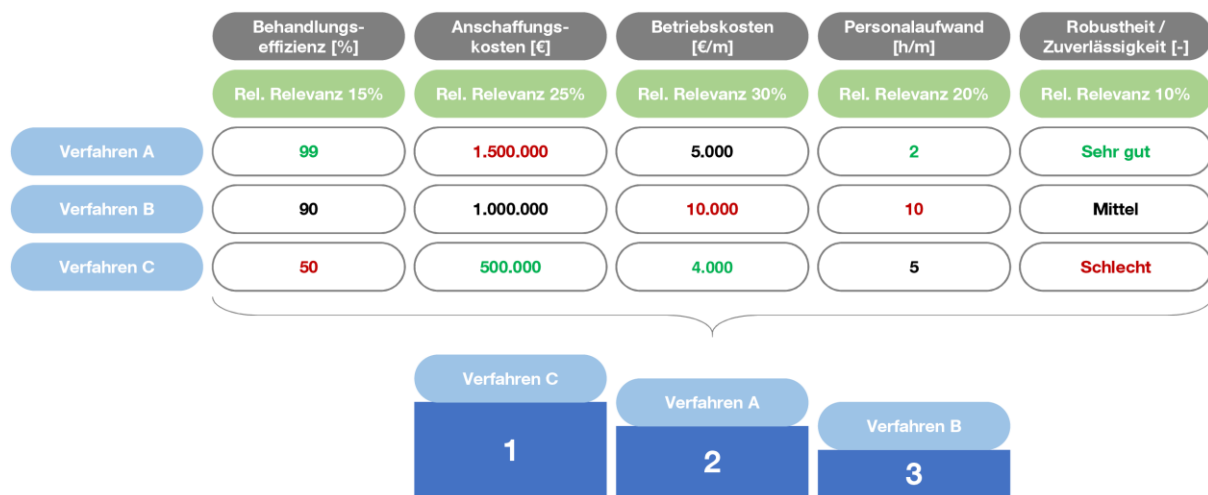
Abb. 6: Schematische Darstellung der Eingabematrix für ein Outranking-Verfahren und der resultierenden Bewertung der drei Verfahren.
